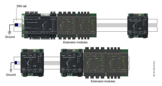
Внимание! Установку модулей OC8/IC8 производить при выключенном электропитании контроллера
