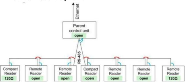
Нагрузочное сопротивление на первом и последнем приборе установлено в 120 Ом, все остальные приборы поставлены без нагрузочного сопротивления.
