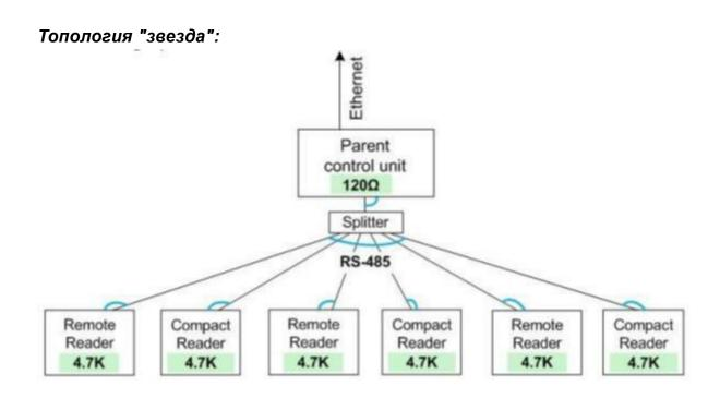
Нагрузочное сопротивление на вышестоящем приборе установлено в 120 Ом, на всех остальных приборах нагрузочное сопротивление установлено в 4,7 кОм.
