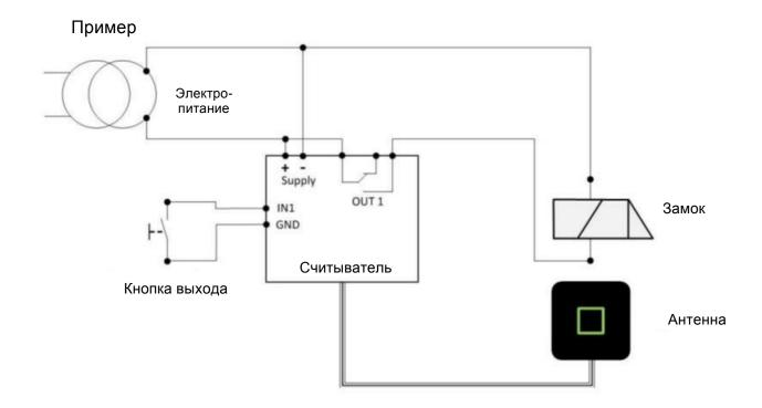
Данный режим подходит для работы с любыми электрическими запорными устройствами – электромеханическая защелка, магнитный замок и т.п.
