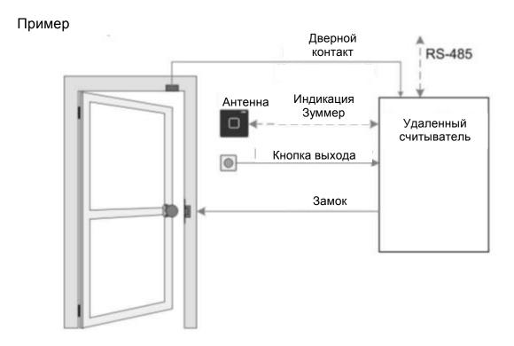
Данный режим подходит для работы с любыми электрическими запорными устройствами – электромеханическая защелка, магнитный замок и т.п.
