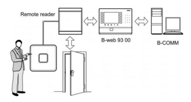
Компактный считыватель работает как подчиненное устройство с терминалами серии B-Web. Коммуникация в режиме реально времени (Online) осуществляется по интерфейсу RS-485 в полудуплексном режиме по протоколу BPA/9 Subset.
