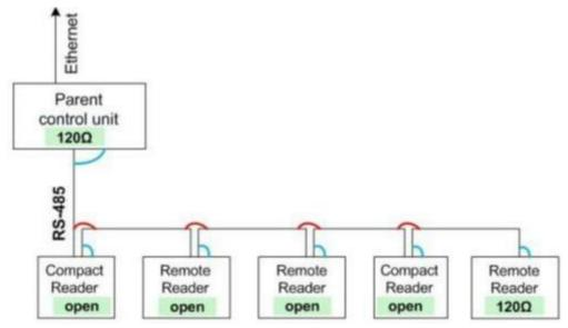
Нагрузочное сопротивление на первом и последнем приборе установлено в 120 Ом, все остальные приборы поставлены без нагрузочного сопротивления.
