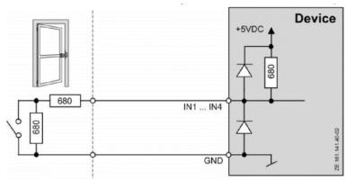
Пример подключения дверного контакта с мониторингом состояния линии. В данном примере линия контролируется на обрыв и короткое замыкание. Однако такое подключение должно быть настроено в системе. В линии используется два сопротивления 680 Ом, 0,25Вт, 2%. Данные сопротивления должны устанавливаться как можно ближе к дверному контакту.
