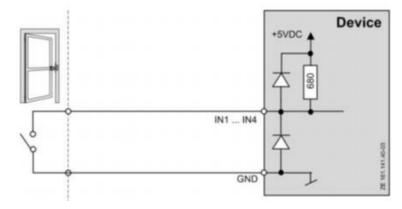
Пример подключения дверного контакта без мониторинга состояния линии. В данном примере манипуляции с линией не контролируются.
